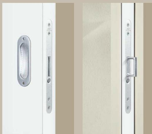
Mit einem Springgriff können Sie das Türblatt bei in der Wand laufenden Schiebetüren komplett in die Wand schieben. Auf Knopfdruck springt der Griff heraus und Sie können die Tür schließen.
